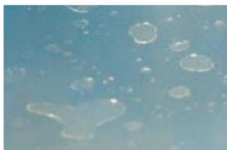
塗膜表面は一見ガラスの様であるが顕微鏡で見れば凹凸があり、一部には穴（多孔質）、へこみがある有機物（プラスチック）、無機物（顔料）で形成されている。その表面に酸性・アルカリ性物質、水、溶液、鳥のフン、樹液、手入れの際のコンパウンド、ワックスを長時間付着させておくと経時により、塗膜を傷めたり、固着して変色（汚れ）したりします。
